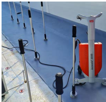
Isoweld® - systém indukčného kotvenia pre ploché strechy
