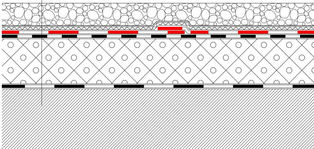
Sanácia strešného plášťa so zateplením EPS s prítaženou dvojvrstvovou asfaltovou krytinou
