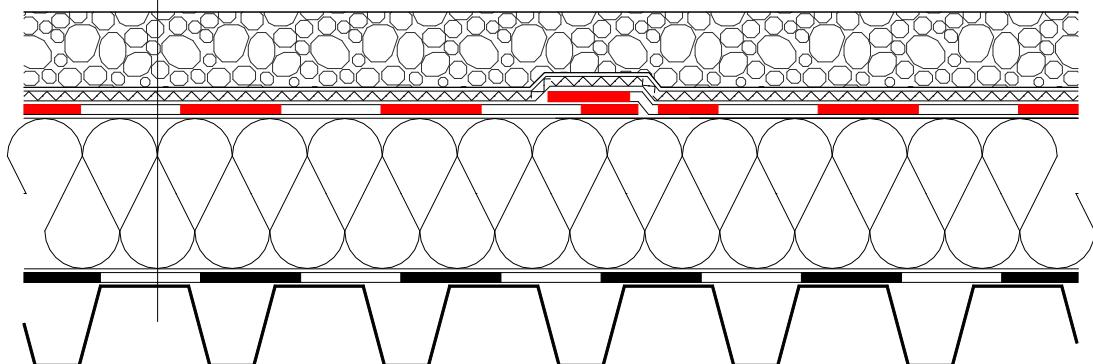
Nový strešný plášť na oceľovom TR plechu so zateplením MW s príťaženou POCB fóliovou krytinou
