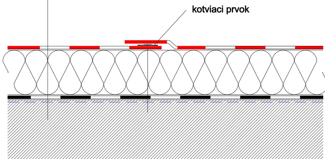
Nový strešný plášť na betónovej konštrukcii so zateplením MW s kotvenou POCB fóliovou krytinou
