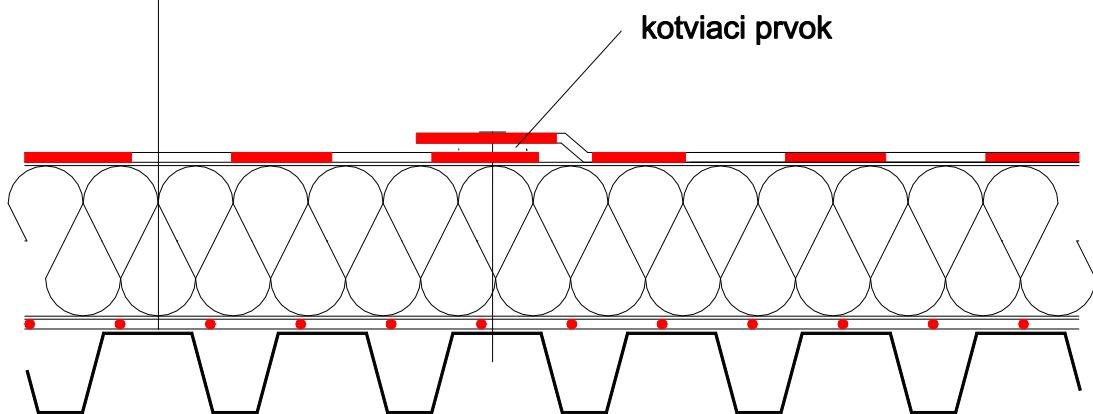
Nový strešný plášť na oceľovom TR plechu so zateplením MW s kotvenou jednovrstvovou asfaltovou krytinou
